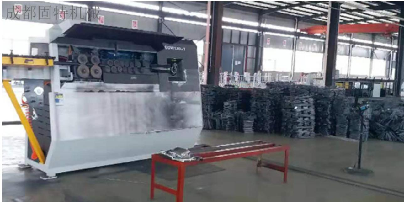
人工校直速度很慢，劳动强度大、造成效率低下。人工校直后每段钢筋的两端要剪掉，剪掉的部分就成了废料，造成了材料的浪费。人工校直过程中，其次拉直的长度很难控制一致，这样在下料时，也会出现料头，同样成了材料的浪费。传统的工作方式越来越不能满足生产的需求，这时就需要使用到全自动智能数控弯箍机，而钢筋弯箍机是钢筋加工企业必备的生产机器之一。数控钢筋弯箍机高精度弯曲、速度稳定操作简单。采用液压工作方式，工作频率可无级调节；8. 采用电阻对焊焊接，焊接接头光滑、牢固；9. 采用可更换精细模具，实现多规格产品的加工；10. 产品成型标准，无变形；
